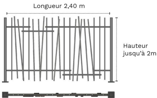
**MicMac O** : 22 barreaux dépassants soudés au centre et en applique de part et d'autre des lisses
