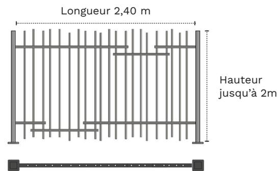
**MicMac D** : 21 barreaux dépassants soudés au centre des lisses
